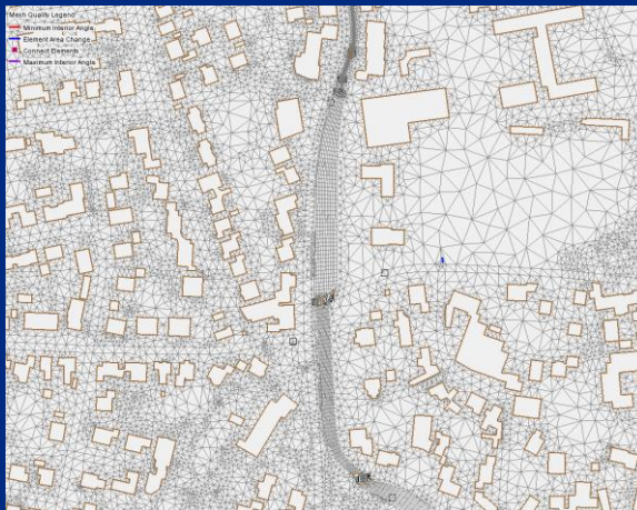
Netzstruktur Flussschlauch (Rechteck), Vorland (Dreieck)
